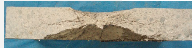
高弾性CFRPシート貼付 (版厚100mm、爆薬量200g)
