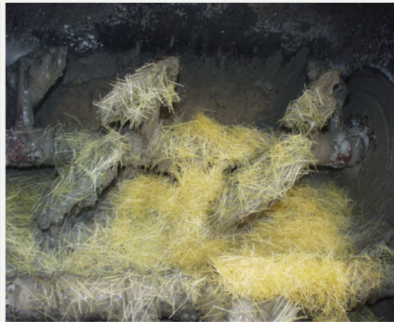
強制攪拌型ミキサーによる 混練
