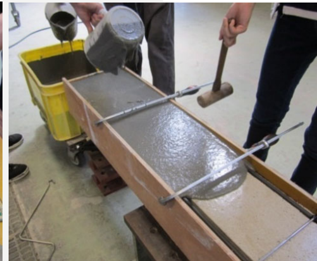
UHPFRC断面増厚 (流込み成型)
