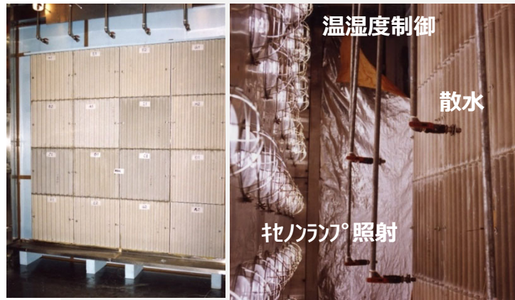
石綿代替繊維強化セメント板の人工気候室 による耐候性試験
