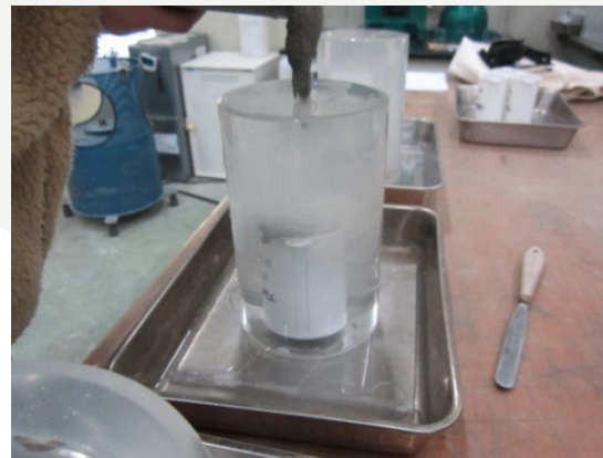
水中作製供試体の作り方
