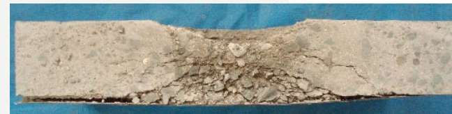
高強度CFRPシート貼付 (版厚100mm、爆薬量200g)
