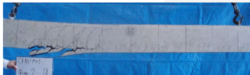
No.2 (CFRPプレート貼付)
