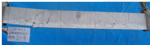
No.3 (高靱性PCM断面修復 + CFRPプレート貼付)
