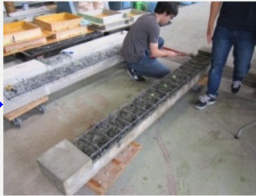
せん断補強筋切断
