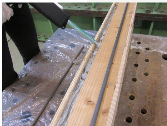
CFRPロッド埋設エポキシ樹脂充填
