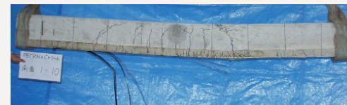
No.6 (高靱性PCM断面修復 + CFRPシート貼付)
