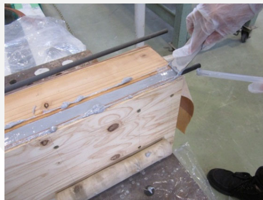
CFRPロッド埋設エポキシ樹脂充填
