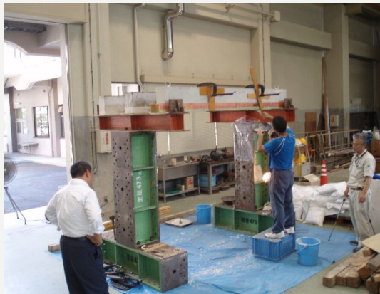
高靱性PCMによる断面修復（上向き施工）
