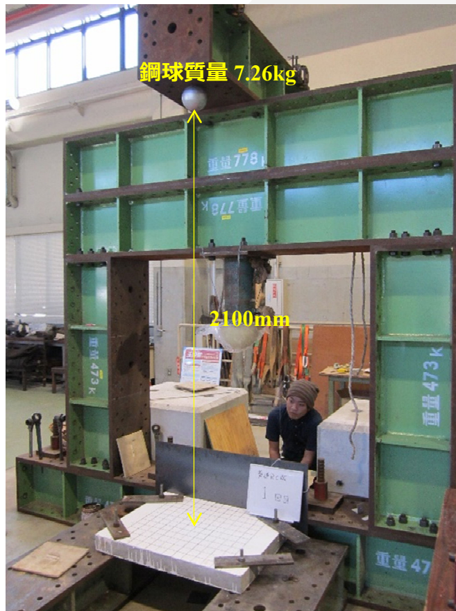
重錘自由落下衝撃試験
