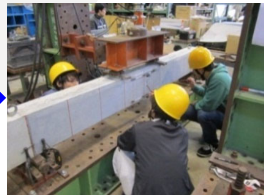
RC梁の曲げ载荷試験
