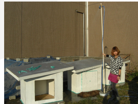
雨音の遮音試験
