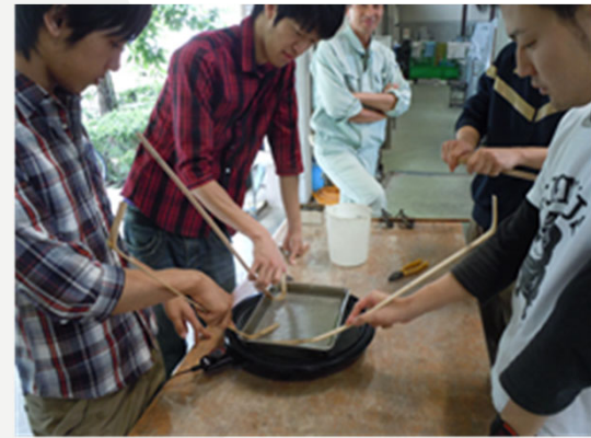
湯煎によるあばら筋加工
