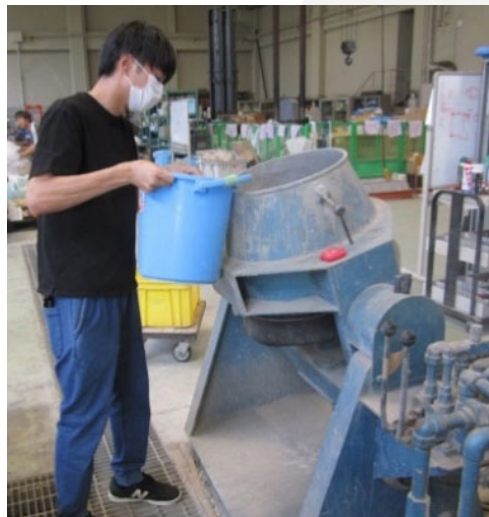
オムニミキサーによる 混練
