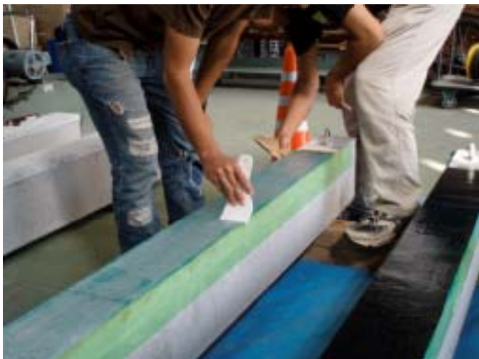
シート・プレート接着工法
