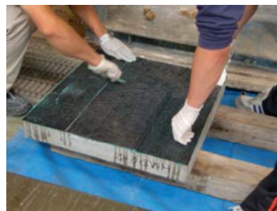
写真 1 シートの接着補強方法
