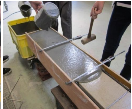
UHPFRC 断面増厚（流込み成型）
