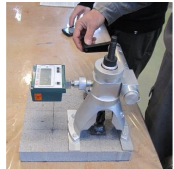
建研式表面接着強度試験 による釘引抜き試験
