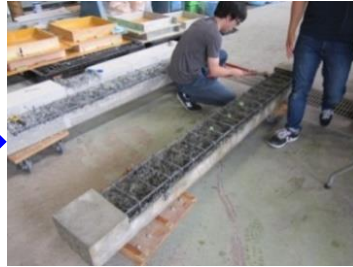
せん断補強筋切断
