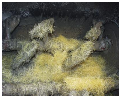
強制二軸攪拌型ミキサーによる混練
