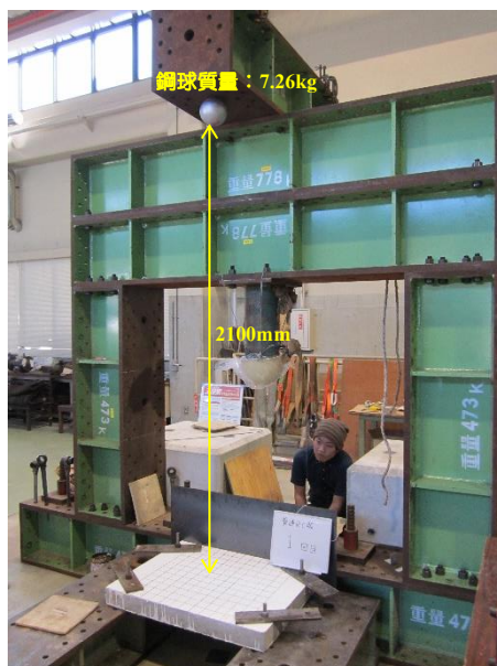
重錘自由落下衝撃試験
