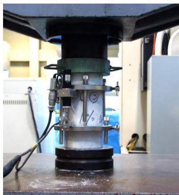
圧縮強度試験
