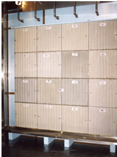
石綿代替繊維強化セメント板の人工気候室による耐候性試験
