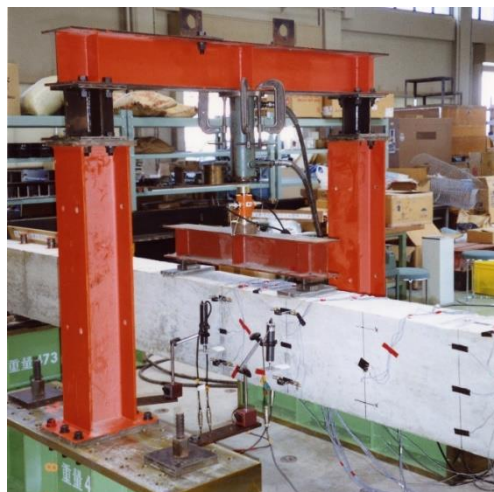
GRC 打込み型枠による RC 梁の曲げ載荷試験
