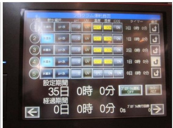
繊維補強コンクリートの乾湿繰返し試験
