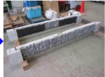
引張鉄筋上に CFRP ロッド配筋
