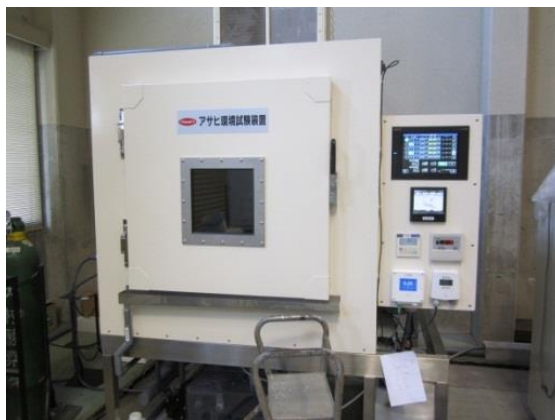
繊維補強コンクリートの乾湿繰返し試験
