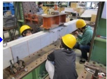
RC 梁の曲げ載荷試験
