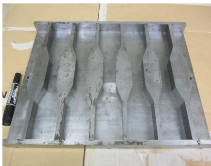
一軸引張強度試験用供試体作製
