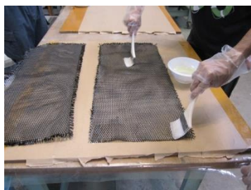
CFRP メッシュプライマー塗布
