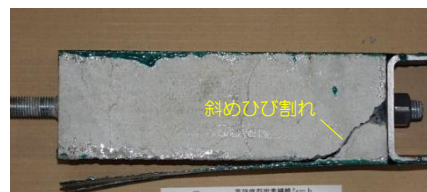
② 斜めひび割れ発生後シート付着剥離
