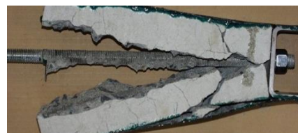
③ 鋼ボルトの付着割裂破壊
