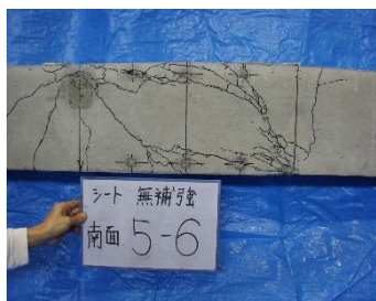
無補強梁の破壊性状
