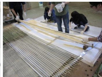
CFRP ロッドプライマー塗布後珪砂散布（付着強度確保）
