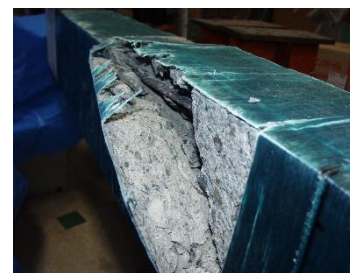
CFRP シート側面貼付+PEFRP シート巻付貼付補強梁の破壊性状
