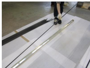
CFRP ロッドプライマー塗布後珪砂散布（付着強度確保）
