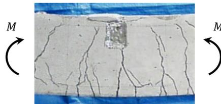
図 3.2.4 曲げひび割れ発生
